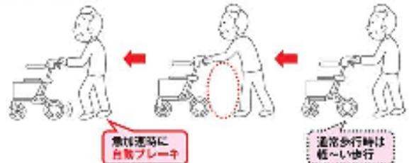
急加速時のみブレーキが作動して「転倒防止!!」
